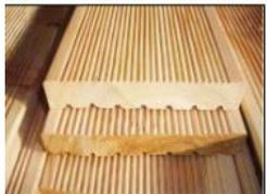
Il piano calpestabile della passerella sarà in doghe in larice con lavorazione antiscivolo. Questa speciale pavimentazione si caratterizza principalmente da un'alta resistenza agli agenti atmosferici. Non cambia colore e non si scacca al sole. Le doghe non necessitano della laccatura dell'acqua. Inoltre è resistente al gelo.
